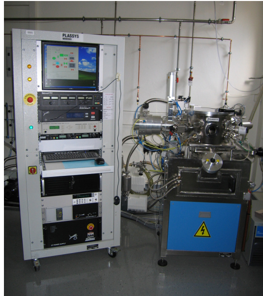
Figure 34 : Photographie de l'évaporateur Plassys MEB 550 S . La chambre de dépôt se trouve à droite, les pompes sont en partie visibles au centre et l'électronique de contrôle et d'alimentation est située dans le rack visible à gauche.
