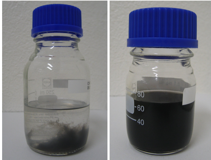
Figure 73 : À gauche, une suspension instable qui décante en moins de 24 heures. À droite, une suspension qui est restée stable pendant deux mois.
